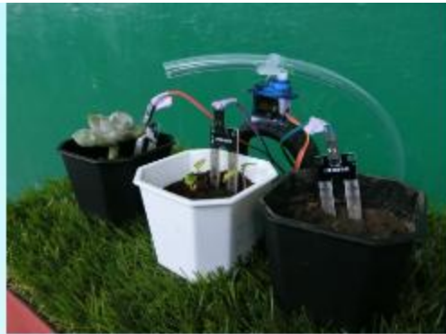
頂部的盆栽個別插入 土壤濕度檢測器
