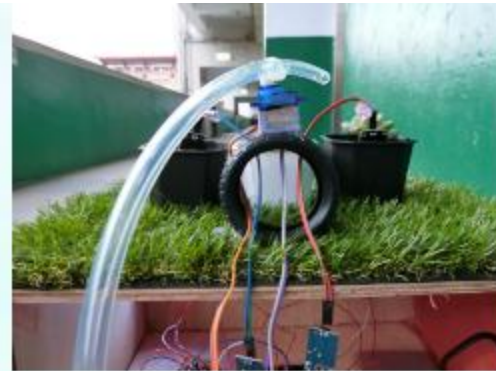
水管分別接在 上方伺服馬達與下方抽水馬達
